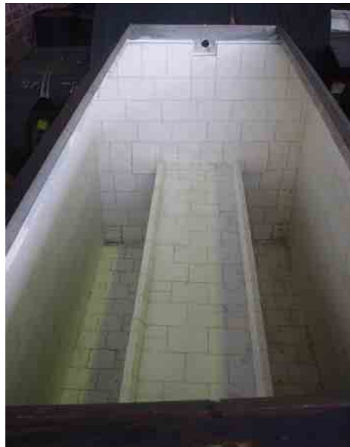
Bremskästen INBA Keramikstärke: 25 +50mm/ Тормозящие опоки Толщина керамики: 25+50 мм
